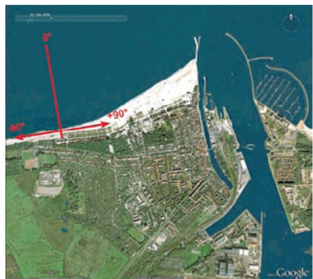
2.13 > Lokales Koordinatensystem für die Berechnung des küstenparallelen Sedimenttransports, Warnemünde (Quelle: URCE)
