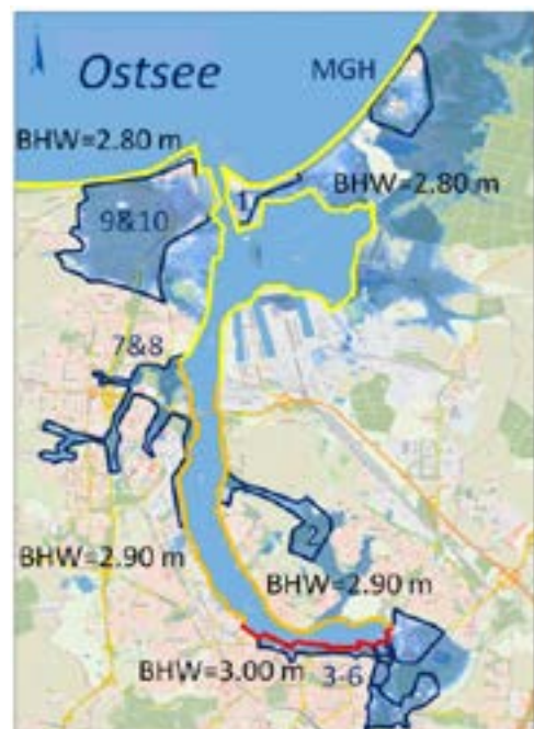
1. 17 > Bemessungshochwasserstände (rot, orange, gelb) und Schutzabschnitte (blau) im Bereich der Hansestadt Rostock
