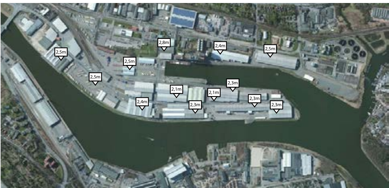
1.61 > Höhenangaben des Terminals Vorwerker Hafen
