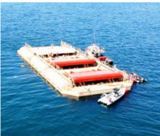
1.28 > Beispiel für Wave Energy Converter
