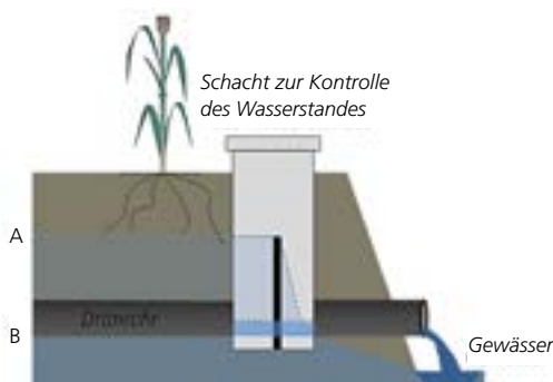
1.48 > Kontrollierte Dränung zum Rückhalt von Wasser und Nährstoffen auf landwirtschaftlichen Flächen. (Quelle: Inga Krämer (IOW) )
