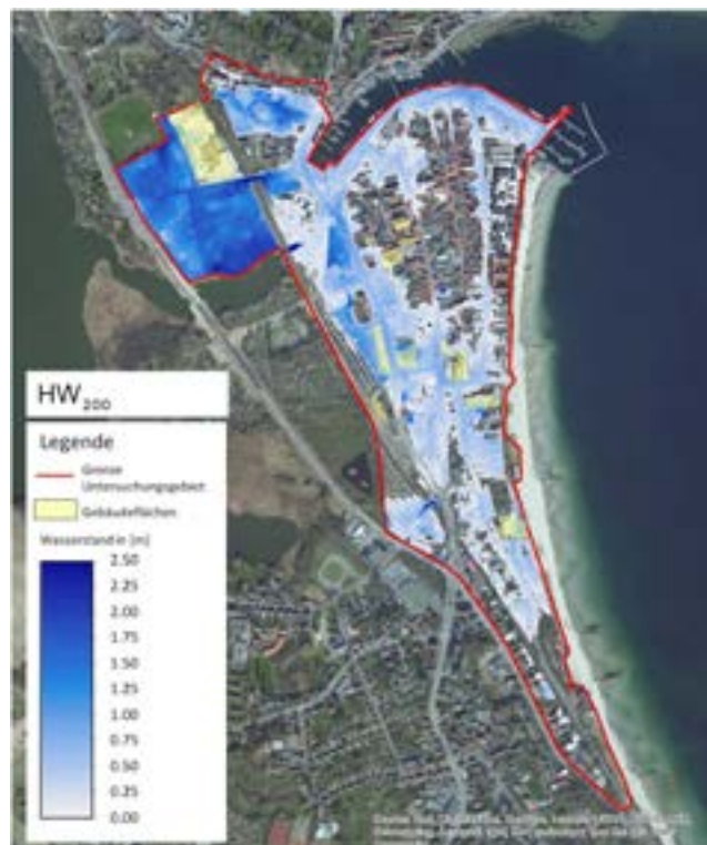
1.15 > Potenziell signifikantes Überflutungsgebiet (LKN-SH) sowie Abgrenzung des Untersuchungsraumes (links); Einstauhöhen bei einem Sturmflutwasserstand von HW 200 = +2,45m ü. NN (rechts) für die Eckernförder Altstadt
