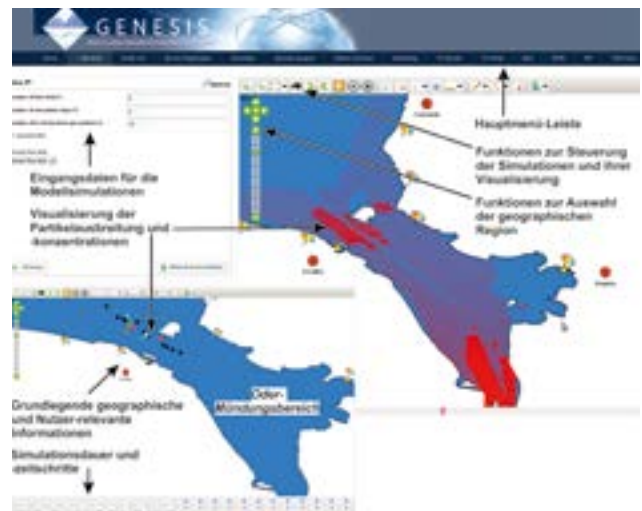
1.42 > Die Internet-Oberfläche des Badewasser-Simulationssystems für das Stettiner Haff 14
