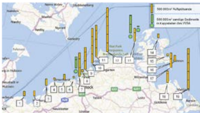
1.29 > Einbaumengen Aufspülsande für den Küstenschutz & verklappte Sande aus Maßnahmen der Wasser- und Schifffahrtsverwaltung in MV über 21 Jahre
